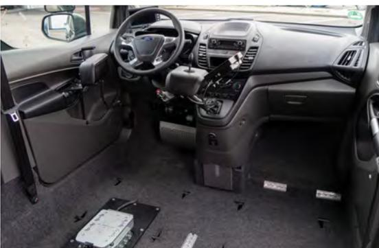
Autofahren mit dem Joystick. Umbau mit digitalen Bedienelementen, Sprachsteuerung uvm. Rollstuhlplatz direkt hinter dem Lenkrad mit Docking-Station für den Rollstuhl am Boden.
